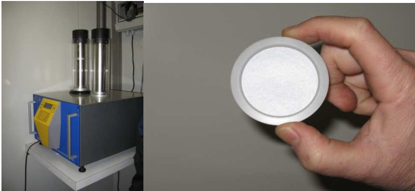
Exempel på mätinstrument för partikelhalter, SM200 med filterkassetter och filter
