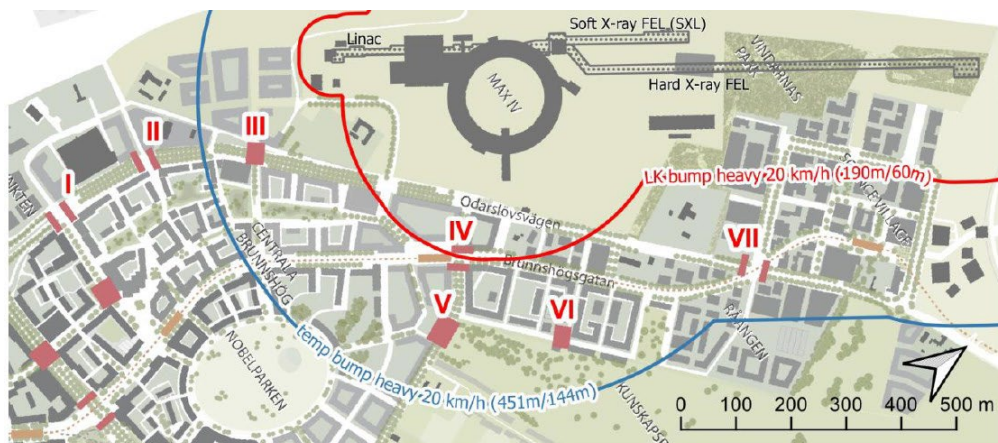
Figur hämtad från testresultatet som redovisar avstånd där risk för vibrationsstörningar till MAX IV föreligger. Figuren redovisar resultat med tungt fordon på 73 t, dvs byggtrafik.
