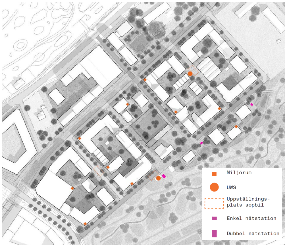
Kartbild som visar placering av föreslagna lösningar kring renhållning och nätstationer i området.
