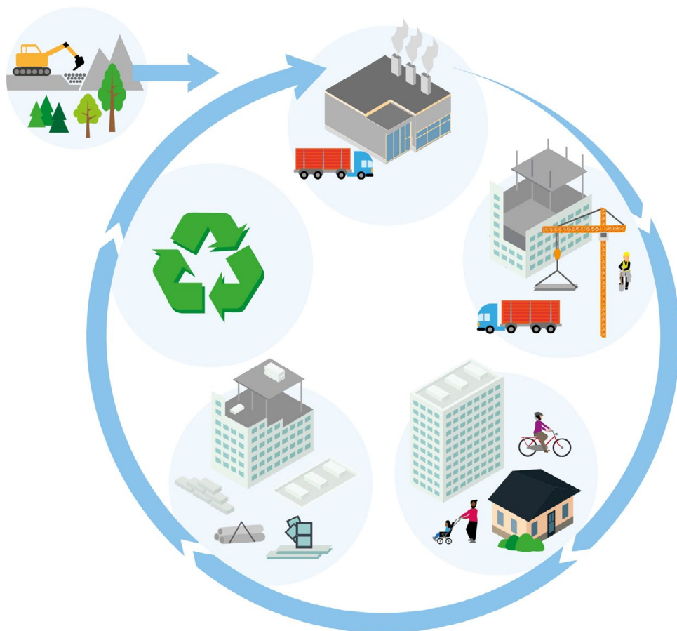
Figur 1: Schablonbild av de olika skedena i en livscykelanalys över en byggnad: utvinning av råvaror, tillverkning av material och transporter, byggarbetsplatsen, drift och demontering. Bild: Infab AB/Boverket
