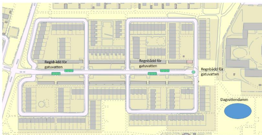
Schematisk bild över dagvattenanläggningar kring Gästgivarevägen.
