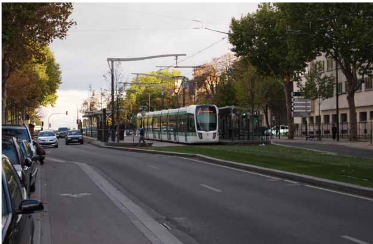
Figur 5-5. Hållplats på linje T3 i Paris. Före och efter hållplatsen ryms gatuparkering (till vänster i bild). Vid hållplatsen används detta utrymme i gaturummet i stället till plattformarna. Situationen motsvarar planskissen i Figur 5-7.
