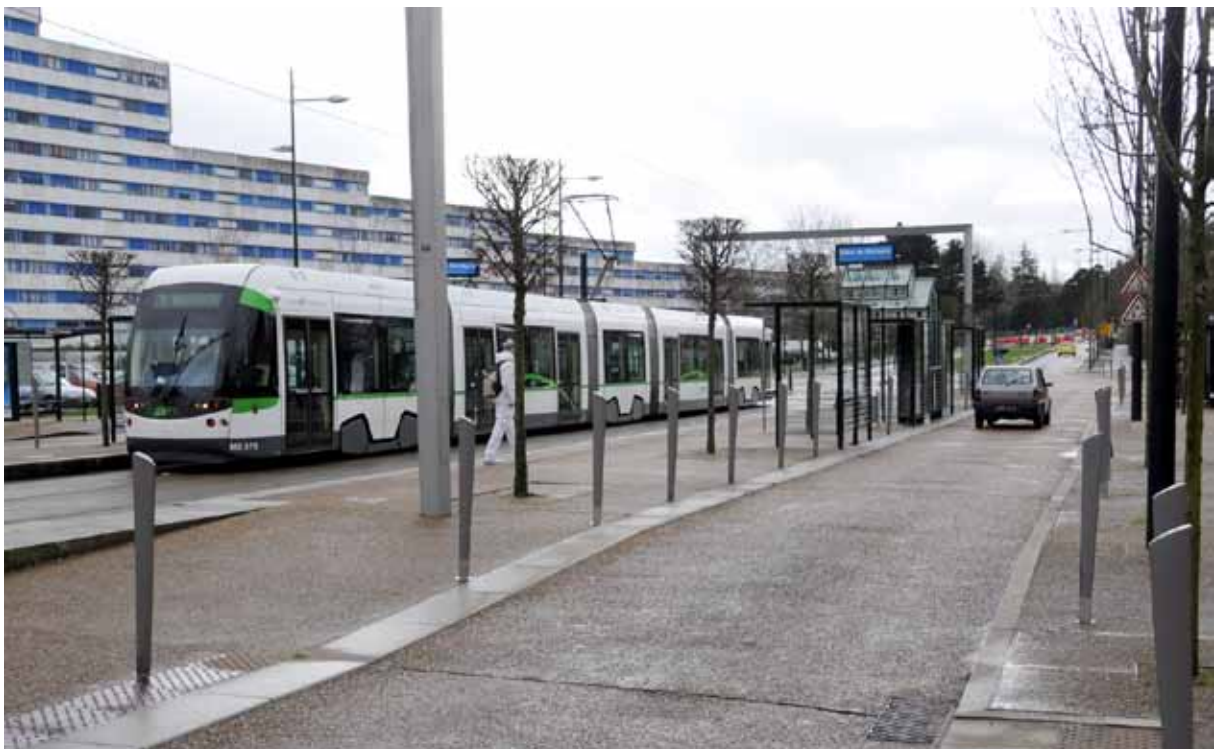
Figur 5-8. Hållplats i franska Nantes med upphöjd köryta för biltrafiken. Fotgängaren får plan mark till trottoaren medan bilen får en upphöjning som sänker hastigheten och uppmärksammar bilföraren på de gående.
