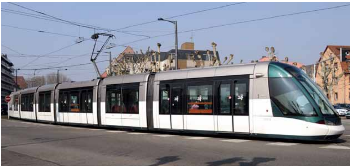
Figur 3-24. Spårvagnar blir tystare om hjulen skyddas som här i Strasbourg.
