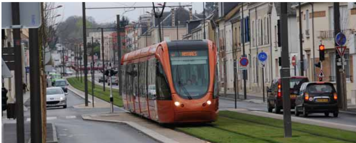
Figur 3-9. Grässpår i Le Mans. Detta skapar både en grönska i stadsmiljön samt ger en viss bullerdämpande effekt.
