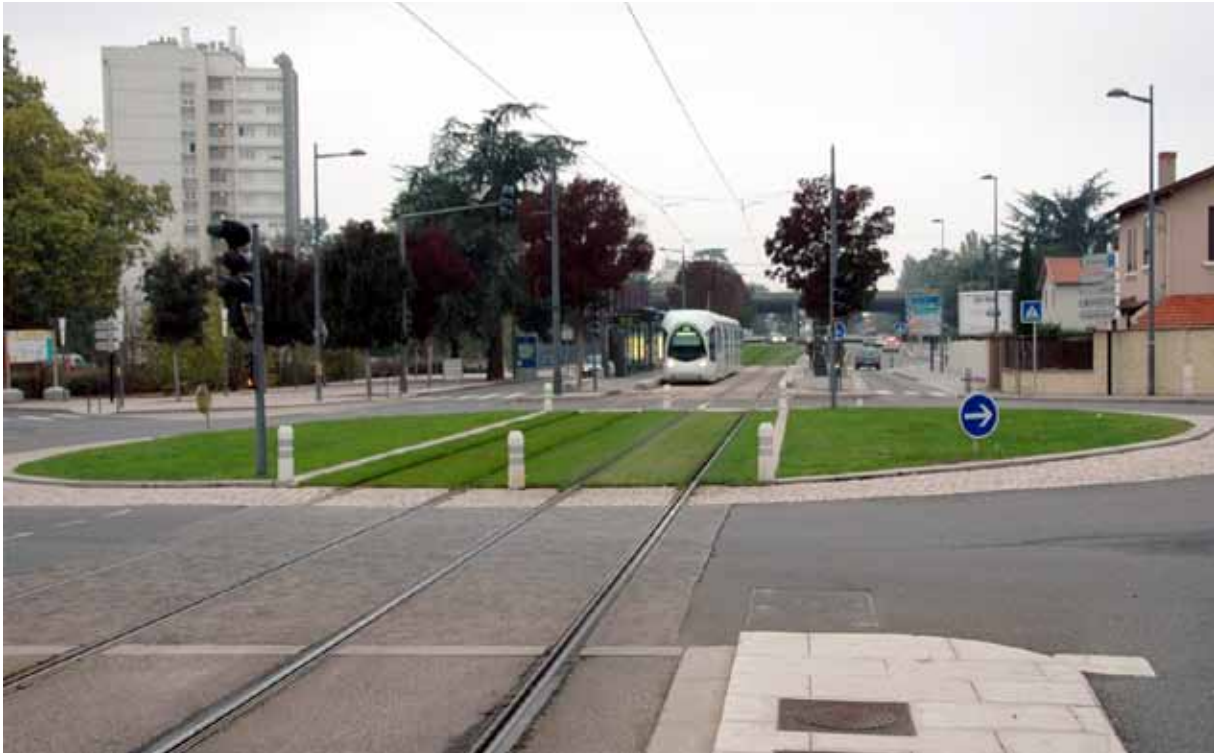
Figur 4-2. Spårvägen passerar genom en cirkulationsplats i Lyon. Spårvagnarnas trafikprioritet, och trafiksäkerheten, säkras med hjälp av signaler.
