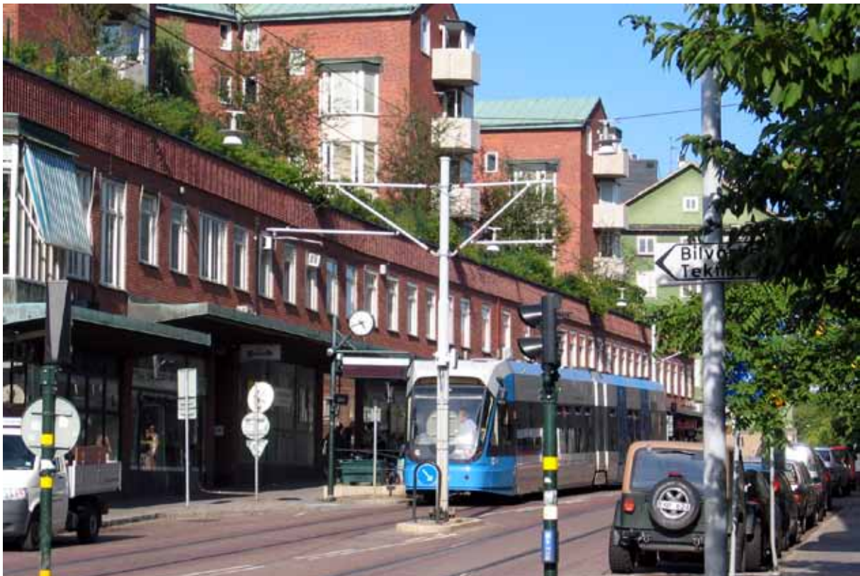
Figur 2-4. Gatuspårväg i Stockholm (Gröndal). Spårvägen går blandad med övrig trafik och risken för stopp bakom bilar i kö är stor. Hastigheten för spårvagnen riskerar att bli låg.
