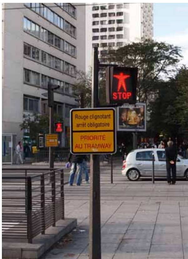
Figur 4-9. Exempel på varningssignal i Paris, med tilläggsskylt som understryker att spårvagnen har företräde. Signalen visar rött sken då spårområdet inte ska beträdas, annars är den släckt.
